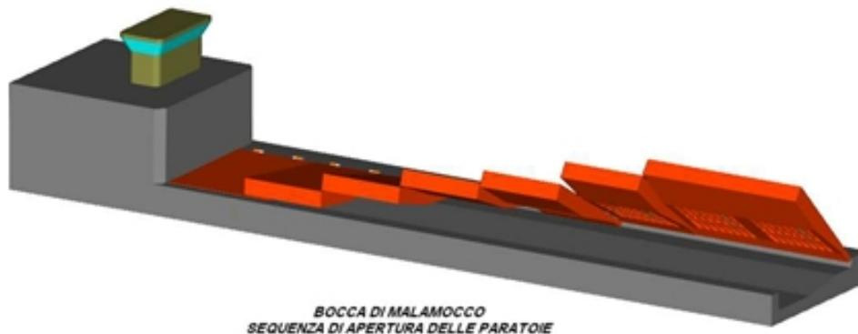
Fig1 Esempio di metà della configurazione della barriera utilizzando il progetto della paratoia a Gravità
